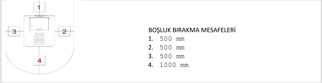
SOBA KURULUM ŞEMASI (ÜST GÖRÜNÜM) ŞEKİL (3)
